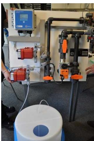
Обзор подключения трубок насоса к баку.
