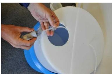
Всасывающая насадка устанавливается внутрь бака.
