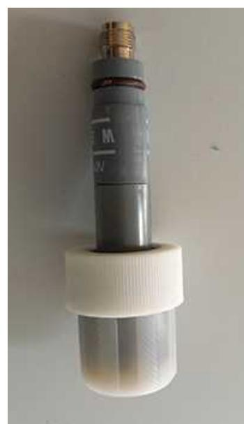
Датчик поставляется незакрепленным в закрытом корпусе, заполненном жидким раствором.
