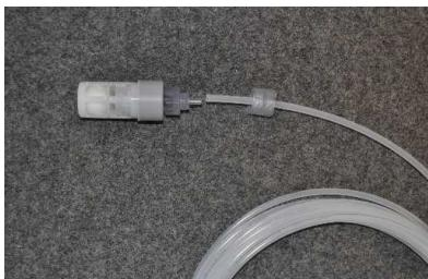
Монтаж трубы на всасывающей насадке.
