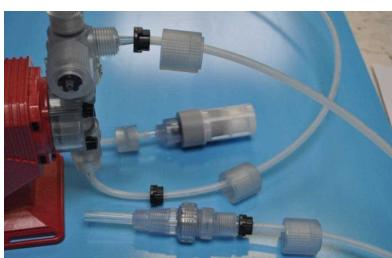
Монтаж деталей трубы на входном патрубке насоса.
