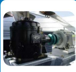
Sistema a motoriduttore ad accoppiamento diretto
