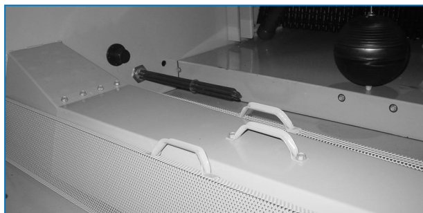
Бассейн холодной воды и сетчатый фильтр бассейна
