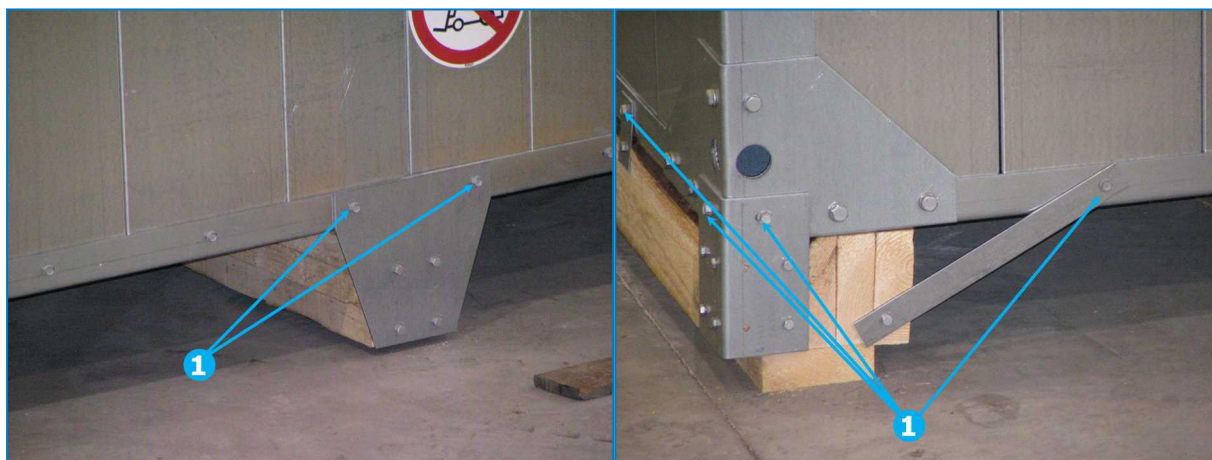
Rimozione della struttura di spedizione, vista laterale & vista posteriore
